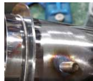
■ステンレス製パイプ 円筒溶接
