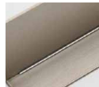
■チタン 板厚t1.0 T字継手溶接
