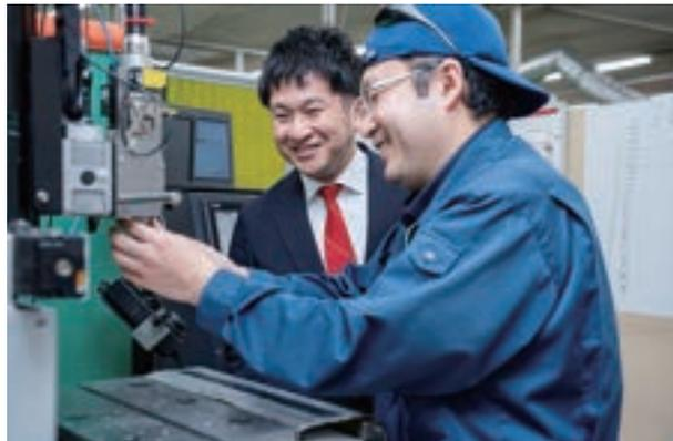
溶接機としましては、ハンドトーチ型ファイバーレーザー溶接機を『OPTICEL FHシリーズ』として製品化しています。ステンレス系やアルミなどの材料毎に応じた溶接機をラインナップしています。ボタンを押すだけでトーチからレーザー光が出射するというもので、手持ちで溶接を可能にする装置です。
